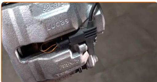
**Utskifting: bremsekaliper – MERCEDES-BENZ C-Klasse T-modell (S203).**
