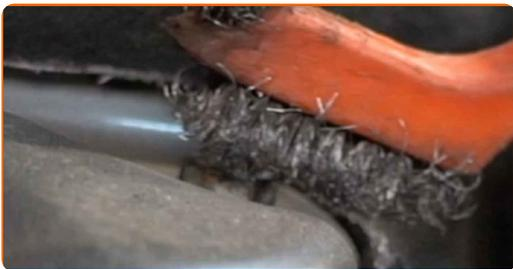
**12** Skru løs de øvre støtdemperfestene. Bruk en pipenøkkelinnsats #13. Bruk en skrallenøkkel.
