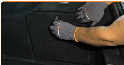
**53** Monter og stram sikringsringen. Bruk Torx T40. Bruk en momentnøkkel. Stram den til 15 Nm dreiemoment.
