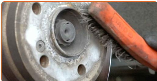
**41** Behandle overflaten hvor bremseskiven kontakter felgen. Bruk keramisk pasta.
