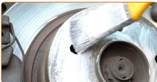
**42** Rengjør overflaten av bremseskiven. Bruk bremsrens.
