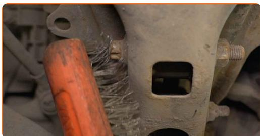
**20** Skru fast det nedre festet på støtdemperen. Bruk Torx E14. Bruk en pipenøkkelinnsats #16. Bruk en skrallenøkkel.
