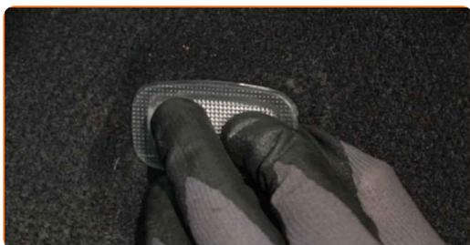
**52** Sett på dekselet til bagasjeromskledningen på siden.
