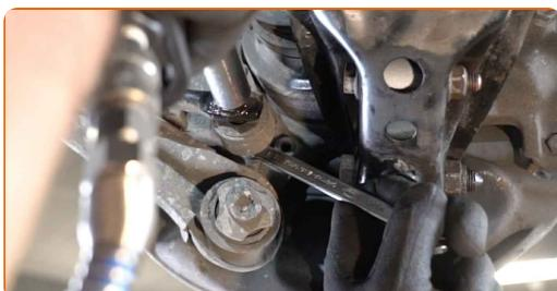
**8** Skru løs festeelementene som fester stabilisatorleddet til styrespindelen. Bruk en pipenøkkelinnsats #E14. Bruk en skrallenøkkel.
