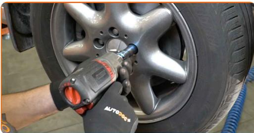
**19** Senk bilen og stram hjulboltene, arbeid på kryss. Bruk en kraftpipe for hjulmutter #17. Bruk en momentnøkkel. Stram den til 110 Nm dreiemoment.
