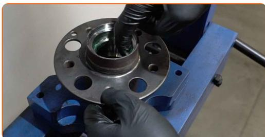
**36** Monter den indre kulebanen til hjullageret i navet. Bruk et avtrekkersett for hylser og lager.
