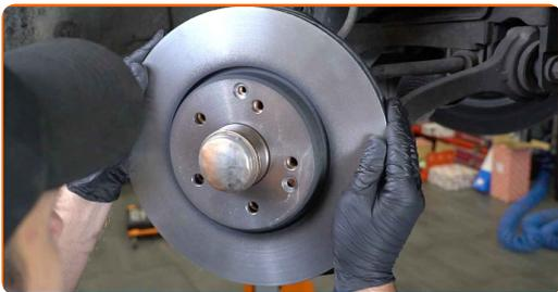
**56** Stram bremseskivefestet. Bruk Torx T30. Bruk en momentnøkkel. Stram den til 9 Nm dreiemoment.
