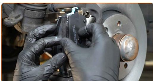
**61** Installer bremsekaliperen og fest den. Bruk en pipenøkkelinnsats #12. Bruk en momentnøkkel. Stram den til 25 Nm dreiemoment.
