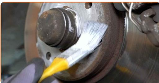
**22** Rengjør overflaten av bremseskiven. Bruk bremsrens.
