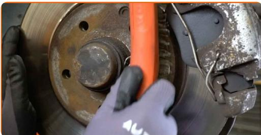
**21** Behandle overflaten hvor bremseskiven kontakter felgen. Bruk keramisk pasta.
