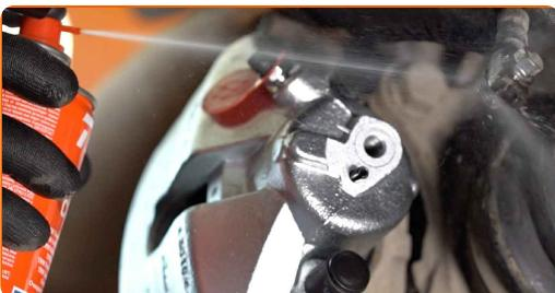
Utskifting: bremsekaliper – MERCEDES-BENZ CLK Kabriolet (A208). AUTODOC
