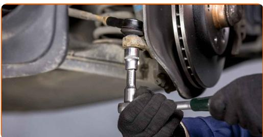
**17** Stram strekkstangens låsemutter. Bruk en kombinasjonsnøkkel #19. Bruk en momentnøkkel. Stram den til 60 Nm dreiemoment.
