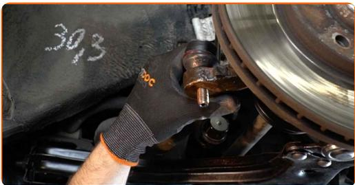
**16** Stram festemutteren som kobler endeledet til rattspindelen. Bruk en pipenøkkelinnsats #19. Bruk en momentnøkkel. Stram den til 50 Nm dreiemoment.
