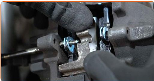
**17** Monter stiften som fester bremseklossene. Bruk en spikerdor. Bruk en hammer.
