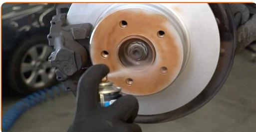
**19** Rengjør overflaten av bremsekiven. Bruk bremserens.
