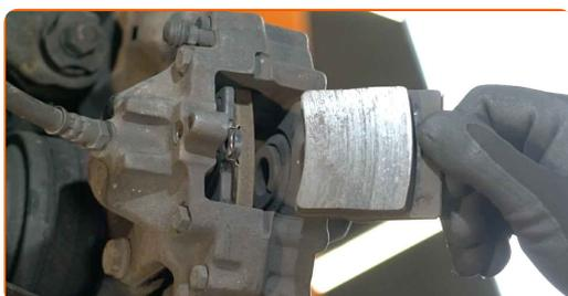
Utskifting: bremseklosser – MERCEDES-BENZ CLK Kabriolet (A209). Tips:
