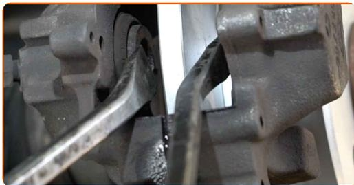
**14** Behandle bremseklossene i området hvor overflaten deres kommer i kontakt med bremsekaliper holderen. Bruk smøremiddel/monteringspasta mot hvining.
