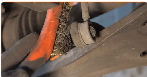
**7** Skru løs festene som kobler stabilisator-ledd til stabilisatorstag. Bruk en kombinasjonsnøkkel #16. Bruk en kombinasjonsnøkkel #22.
