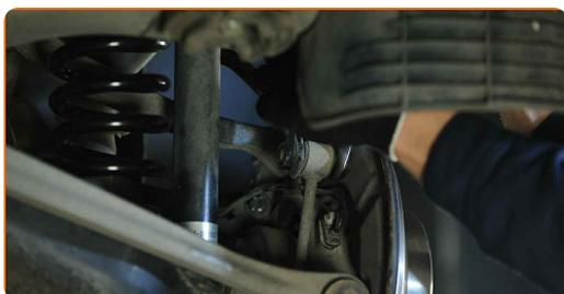
**8** Skru løs festelementene som fester stabilisatorleddet til styrespindelen. Bruk en kombinasjonsnøkkel #16. Bruk en pipenøkkelinnsats #16. Bruk en skrallenøkkel.
