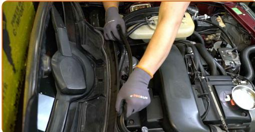
4 Fjern hovedelementet som fester pakningen til vindusviskerens torpedoplate.
