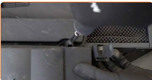
**10** Fjern luftfilterdekslene sammen med filterelementene.
