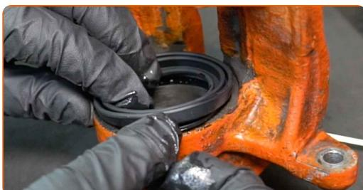
**Utskifting: bremsekaliper reparasjonssett – MERCEDES-BENZ E-Klasse T-modell (S124). AUTODOCs eksperter anbefaler:**
