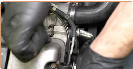
**4** Bruk en spak med passende diameter til å løse spennarmen og fjerne festebolten. Bruk en forlenger 3/8" med firkantinnfestning.
