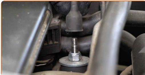
**4** Rengjør det øvre festet til støtdemperen. Bruk en stålborste. Bruk WD-40 spray.
