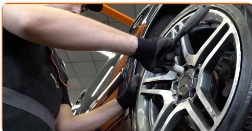
**36** Senk bilen og stram hjulboltene, arbeid på kryss. Bruk en kraftpipe for hjulmutter #17. Bruk en momentnøkkel. Stram den til 112 Nm dreiemoment.
