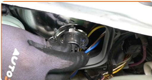
**Utskifting: hovedlyspærer – MERCEDES-BENZ G-Klasse SUV (W463).**
