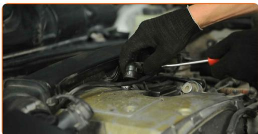
**7** Koble røret til luftinntaket fra luftfilterhuset.
