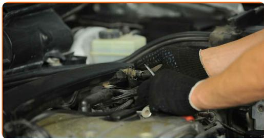
**5** Løsne slangeklemmen på luftinntaket. Bruk en flat skrutrekker.
