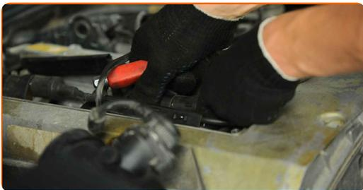
**13** Fjern ledningskontaktene til tennpluggene fra hullene til tennpluggene.
