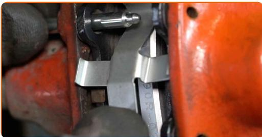
**45** Monter styrepinnene til bremseklossen. Bruk en spikerdor. Bruk en hammer.
