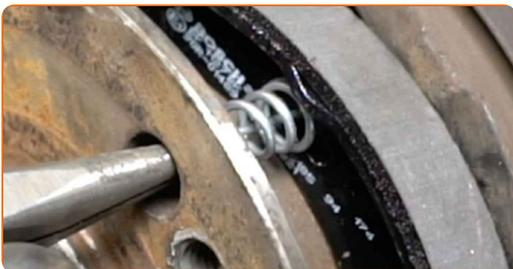
**33** Monter den nedre returfjæren. Bruk en flat skrutrekker.
