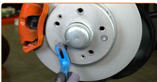
**46** Behandle overflaten hvor bremseklaffen kontakter felgen. Bruk keramisk pasta.
