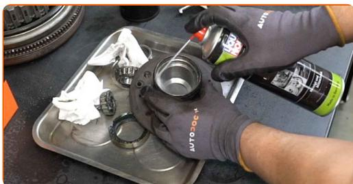
**27** Monter de ytre banene til de nye hjullagrene. Bruk et avtrekkersett for hylser og lager.
