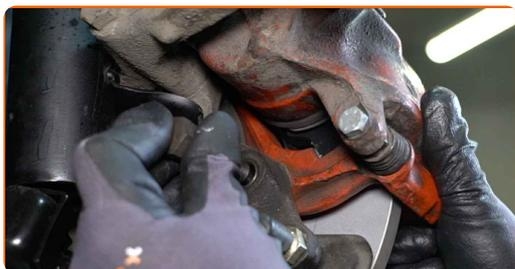
**44** Stram festene til braketten til bremsekaliperen. Bruk en pipenøkkelinnsats #19. Bruk en momentnøkkel. Stram den til 115 Nm dreiemoment.
