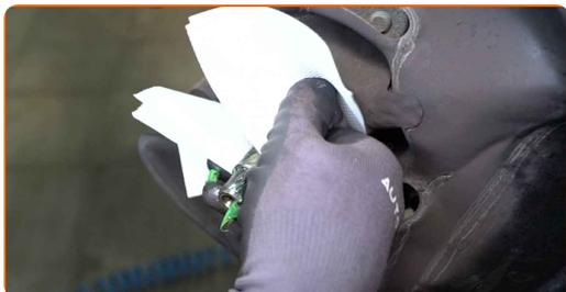
**23** Rengjør ABS-sensoren. Bruk en rengjøringsbørste av nylon. Bruk universal rengjøringspray.
