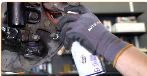
10 Skru løs festene til braketten til bremsecaliperen. Bruk en kombinasjonsnøkkel #19.
