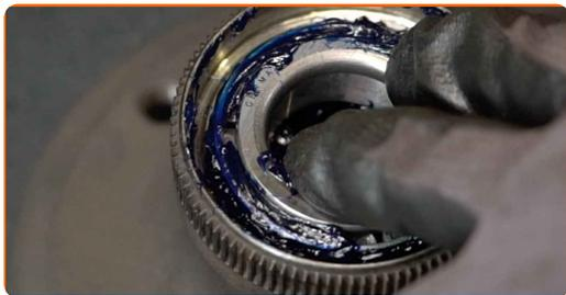
**30** Monter oljepakningen til hjullageret. Bruk et avtrekkersett for hylser og lager.
