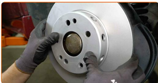
**17** Fjern dekselet til navlageret. Bruk et brekkjern. Bruk en hammer.
