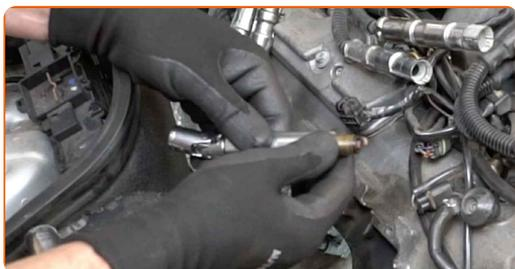
**15** Påfør et tynt lag med et spesielt høytemperaturfett på gjengene til de nye tennpluggene.
