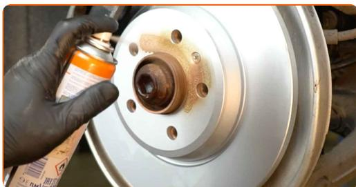
**20** Rengjør overflaten av bremseskiven. Bruk bremsrens.
