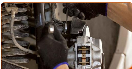
**15** Monter festet som forbinder stabilisatorstaget og bæreamen og stram det. Bruk en kombinasjonsnøkkel #13. Bruk en pipenøkkelinnsats #13. Bruk en pipenøkkelinnsats #17. Bruk en momentnøkkel. Stram den til 20 Nm dreiemoment.
