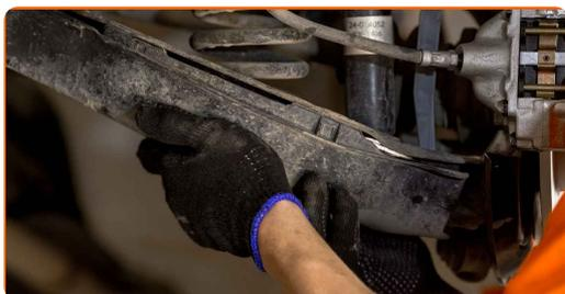
**18** Skru fast festene til bæreamens plastdeksel. Bruk en pipenøkkelinnsats #10. Bruk en skrallenøkkel.
