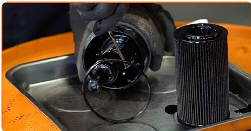
**15** Rengjør lokket til oljefilterhuset. Bruk universal rengjøringspray.
