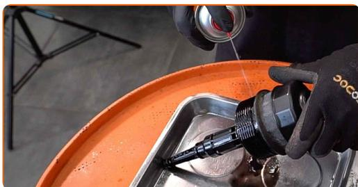
**16** Installer nye O-ringer til filterdekselets monteringsfester.
