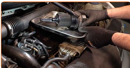
**Utskifting: motorolje og oljefilter – MERCEDES-BENZ Sprinter 3-T Van (W903).**
