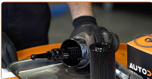
**14** Fjern gammel O-ring fra dekselet til oljefilteret. Bruk en flat skrutrekker.
