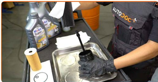
**14** Fjern gammel O-ringe fra dekselet til oljefilteret. Bruk en flat skrutrekker.
