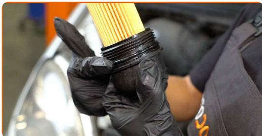
**23** Installer et nytt oljefilterhusdeksel og stram det. Bruk en pipenøkkelinnsats #32. Bruk en momentnøkkel. Stram den til 25 Nm dreiemoment.
