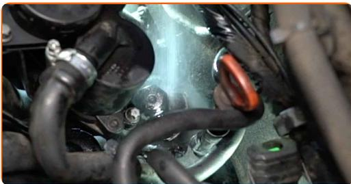
**6** Skru løs filterhushetten sammen med det gamle filterelementet. Bruk en pipenøkkelinnsats #32. Bruk en skrallenøkkel.
