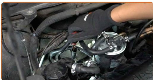
**5** Rengjør oljefilteret. Bruk universal rengjøringspray.
