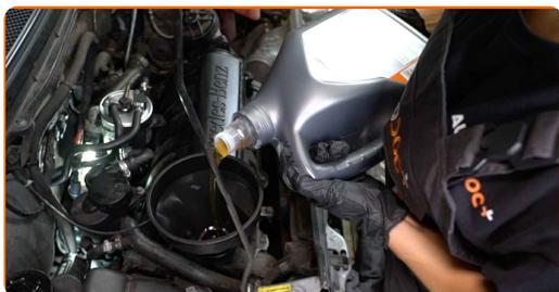
Utskifting: motorolje og oljefilter – MERCEDES-BENZ Vaneo (414). Tips fra AUTODOCs eksperter:
