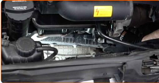
**4** Skru løs tennspolebraketten. Bruk en pipenøkkelinnsats #E11. Bruk en skrallenøkkel.
