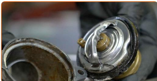
**23** Rengjør festepunktet til termostaten. Bruk en stålbørste. Bruk universal rengjørings-spray.
