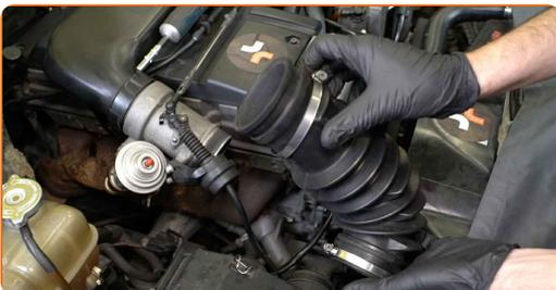
**5** Dekk til gasspjeldet med en mikrofiberklut for å forhindre at støv og smuss kommer seg inn i systemet.
