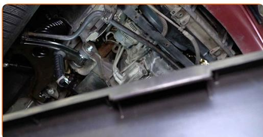
**9** Åpne tappehanen for kjølevæske. Bruk en flat skrutrekker.
