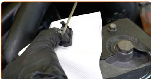
**36** Koble til kontakten til temperatursensoren for kjølevæske.
