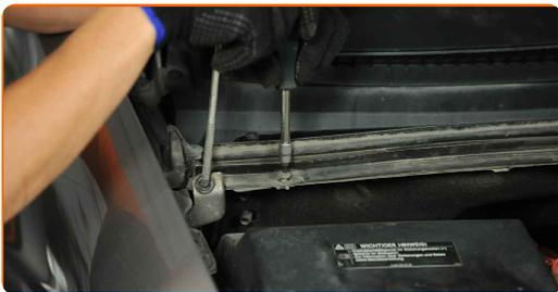
**19** Fjern klemmene fra plastgrillen på panseret. Bruk en flat skrutrekker. Bruk en øreklemmetang.
