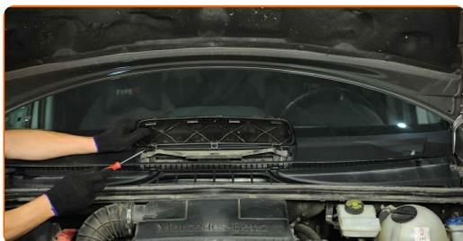
**24** Ta ut kupøfilterbraketten. Bruk Torx T25. Bruk en skrallenøkkel.
