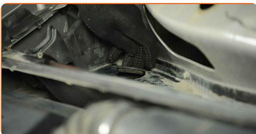
**53** Sett inn kontakten til vindusviskermotoren.
