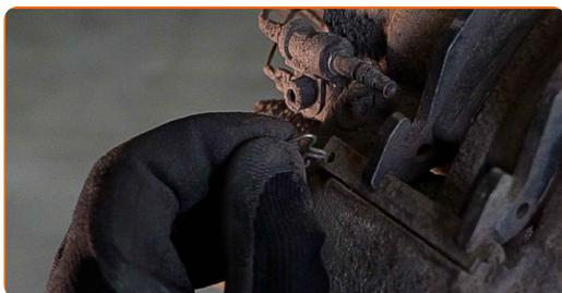
**10** Ta bort låseklippsen til bremseklossene. Bruk et brekkjern. Bruk en gummihammer.
