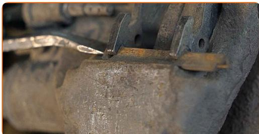
**11** Fjern bremseklossene. Bruk et brekkjern.
