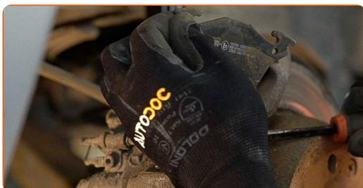
**12** Rengjør festene til bremsecaliperen. Bruk en stålbørste. Bruk WD-40 spray.
