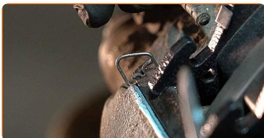
24 Monter låsefjærene til bremseklossene.
