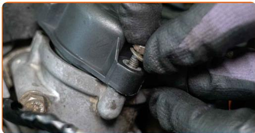
**20** Stram festene til termostathuset. Bruk en pipenøkkelinnsats #10. Bruk en momentnøkkel. Stram den til 12 Nm dreiemoment.
