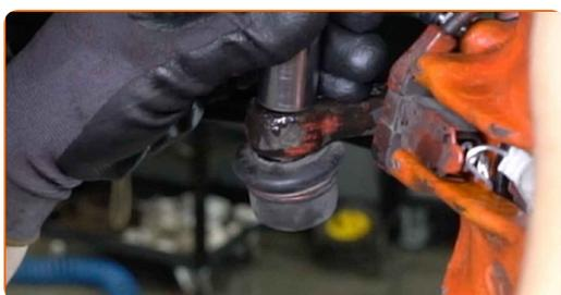
**12** Skru løs festelementene som forbinder endeledet til bæreamen. Bruk en pipenøkkelinnsats #17. Bruk en skrallenøkkel.
