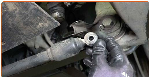
**10** Rengjør festene til endeledet. Bruk en stålbørste. Bruk WD-40 spray.
