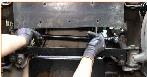
**28** Stram festene som kobler endene til parallellstaget til bæreamene. Bruk en pipenøkkelinnsats #19. Bruk en momentnøkkel. Stram den til 35 Nm dreiemoment.
