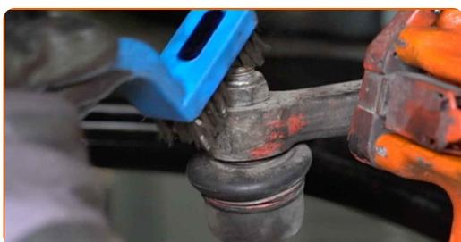
**11** Skru løs festemutteren som fester endeledet til styrespindelen. Bruk en pipenøkkelinnsats #17. Bruk en skrallenøkkel.
