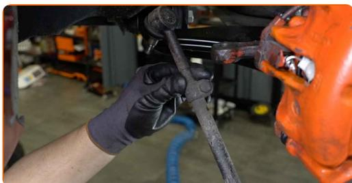
**16** Rengjør festene til endeledet. Bruk en stålbørste. Bruk WD-40 spray.
