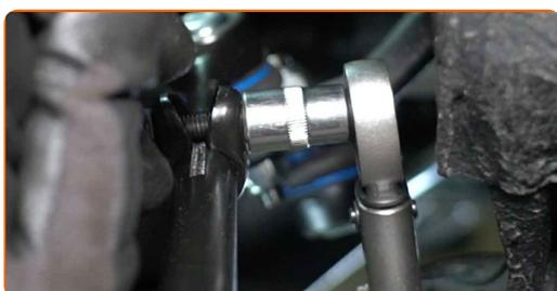
**32** Stram strekkstangendens låsemutter. Bruk en kombinasjonsnøkkel #22. Bruk en momentnøkkel. Stram den til 50 Nm dreiemoment.
