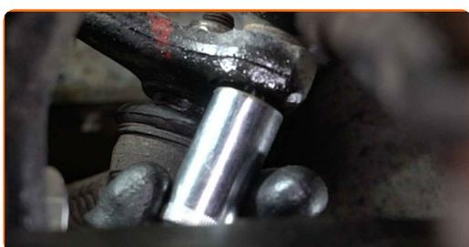
**13** Løs endeledet fra styrespindelen. Bruk en avtrekker for kuleledd.
