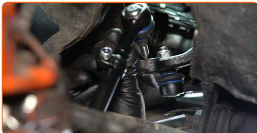
**31** Stram festbolten til endeledet. Bruk en kombinasjonsnøkkel #13. Bruk en pipenøkkelinnsats #13. Bruk en momentnøkkel. Stram den til 20 Nm dreiemoment.
