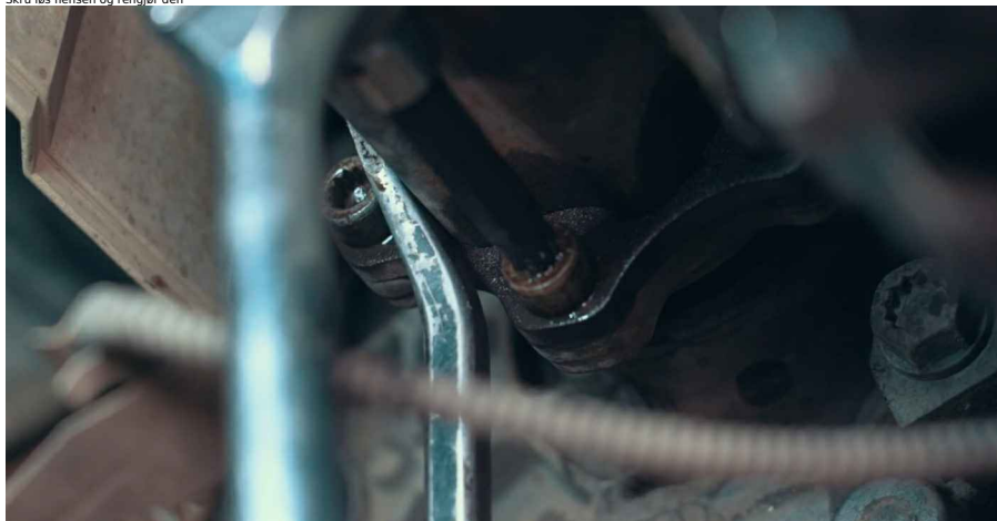
11 Monter en ny drivaksel
