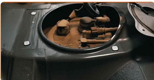
6 Dersom drivstoffilteret er plassert i tanken, er det et deksel under baksetet eller i bagasjerommet som gjør at man får tilgang enklere
