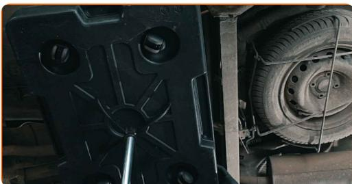
8 Et drivstoffilter i tanken kan danne en enhet sammen med pumpen og drivstoffnivåføleren. Disse komponentene byttes ofte sammen som en montasje
