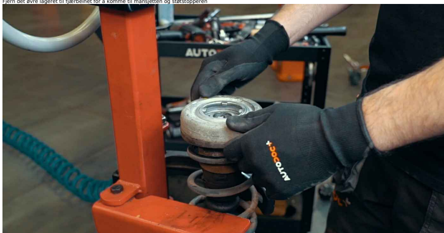
13 Fjern det øvre lageret til fjærbeinet for å komme til mansjetten og statstopperen
