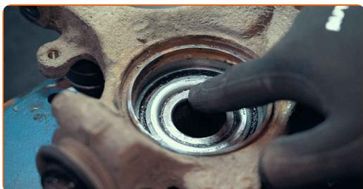
**29** Finn diameteren til hjulnavet og bruk hjullagerverktøy med rett størrelse
