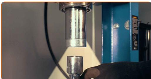
**27** Plasser styrespindelen på de lastebærende punktene så den ikke blir deformert
