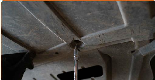
**8** Fjern dekselet til oljepannen. Bruk en pipenøkkelinnsats #10. Bruk en flat skrutrekker.
