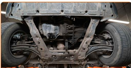
**9** Plasser en beholder for avfallsolje, med minst 5 l. kapasitet, under dreneringshullet.
