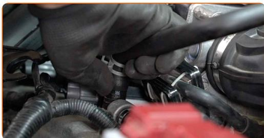
34 Stram klemmen og festene på inntaksrøret til luftfilteret. Bruk en pipenøkkelinnsats #10. Bruk en skrallenøkkel.
