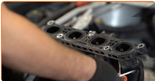
**22** Fjern pakningen til innsugningsmanifolden. Bruk en flat skrutrekker.
