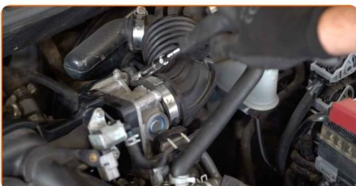
**5** Koble røret til luftinntaket fra luftfilterhuset.
