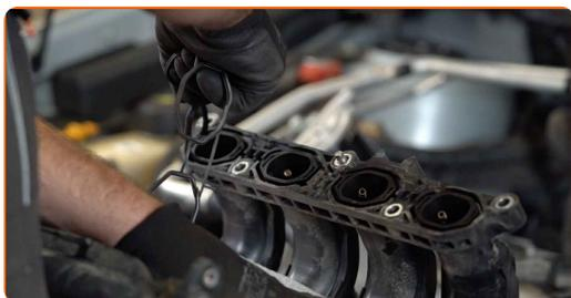
**23** Installer ny pakning på innsugningsmanifolden.
