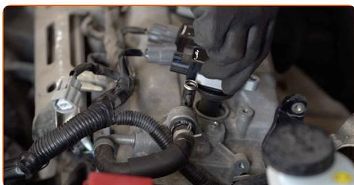
**18** Behandle pluggen til tennspolen med elektro spray. Sprayen beskytter den elektriske kontakten mot korrosjon og oksidasjon, samt reduserer kontaktmotstand.
