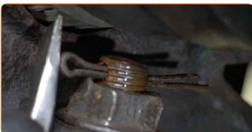
**71** Stram nedre fester som kobler fjærbein til styrespindel. Bruk en kombinasjonsnøkkel #17. Bruk en pipenøkkelinnsats #19. Bruk en momentnøkkel. Stram den til 140 Nm dreiemoment.
