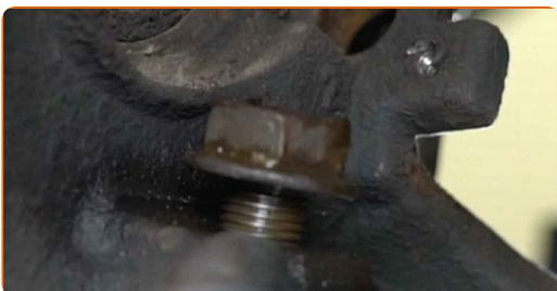
**42** Koble kuleleddet fra styrespindelen. Bruk en avtrekker for kuleledd.
