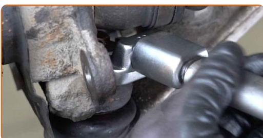
**70** Monter saksesplinten som holder festet som kobler bærekulen til styrespindelen. Bruk et brekkjern.
