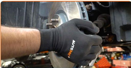
**15** Skru kuleleddfestet til styrespindelen. Bruk en kombinasjonsnøkkel #18. Bruk en pipenøkkelinnsats #18. Bruk et svingjern.
