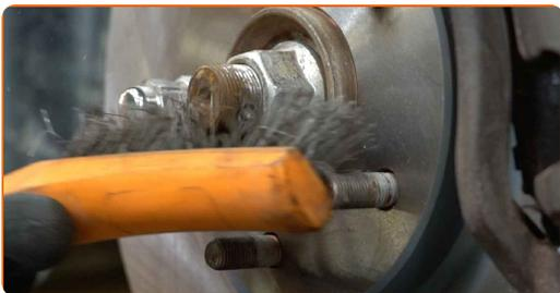
**7** Fjern saksesplinten til akselmutteren. Bruk et brekkjern.
