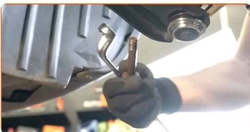
**17** Koble fra ABS-sensorens ledninger. Bruk et demonteringsverktøy for klemmer.
