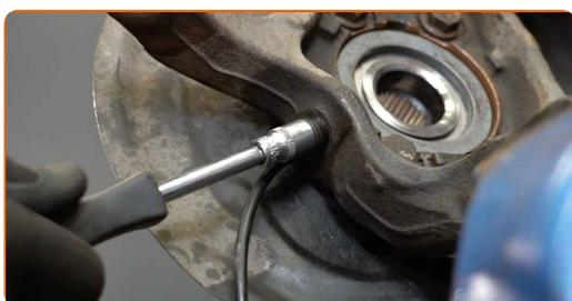
**43** Behandle festene til hjulnavlageret med et egnet middel. Bruk kobberfett.
