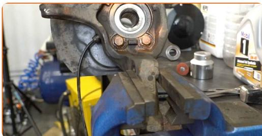
**45** Installer styrespindelen med et nav i monteringen.
