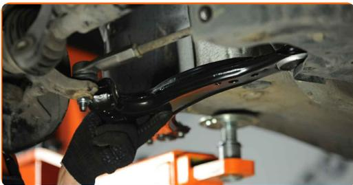
25 Monter festene på kontrollarmen. Bruk en flat skrutrekker. Bruk en gummihammer.
