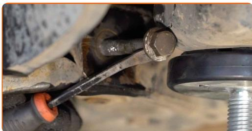
**14** Skru løs de bakre festene som tilkobler bærearman til under rammen. Bruk en kombinasjonsnøkkel #18. Bruk en pipenøkkelinnsats #18. Bruk en skrallenøkkel.
