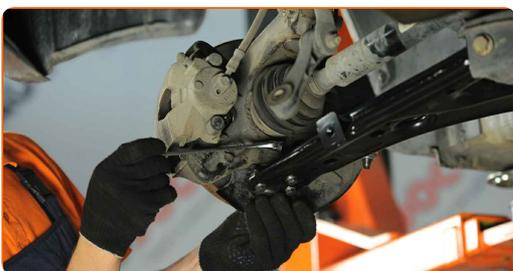
28 Støtt armen. Bruk en hydraulisk jekk.
