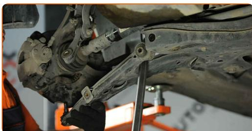
**17** Skru løs festene som binder kuleleddet til kontrollarmen. Bruk en pipenøkkelinnsats #13. Bruk en skrallenøkkel.
