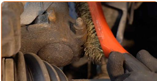
**11** Skru løs nedre feste som kobler fjærbein til styrespindel. Bruk en kombinasjonsnøkkel #18. Bruk en pipenøkkelinnsats #18. Bruk en skrallenøkkel.
