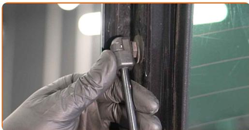
**15** Klem på sikringsringen som kobler gassfjæren til karosseriet.
