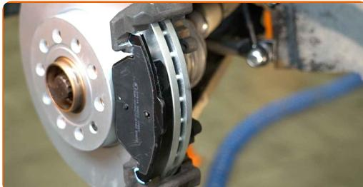
Utskifting: bremsekaliper – Skoda Octavia 1Z5. AUTODOCs eksperter
