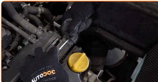
**4** Skru løs tennspolebraketten. Bruk Torx T30. Bruk en skrallenøkkel.
