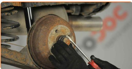
**7** Fjern splinten som sikrer navmutteren. Bruk en rundtang.
