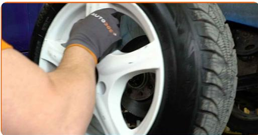
**15** Skru løs festene som binder drivaksel til hjulnavet. Bruk en pipenøkkelinnsats #30. Bruk en skrallenøkkel.
