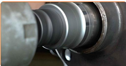
**73** Rengjør navet. Bruk en stålbørste. Behandle deretter kontaktflaten. Bruk keramisk pasta.
