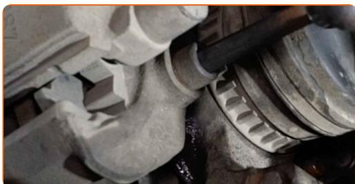
**78** Stram festet som forbinder bærekulen og styrespindelen. Bruk en kombinasjonsnøkkel #18. Bruk en pipenøkkelinnsats #18. Bruk en momentnøkkel. Stram den til 30 Nm dreiemoment.
