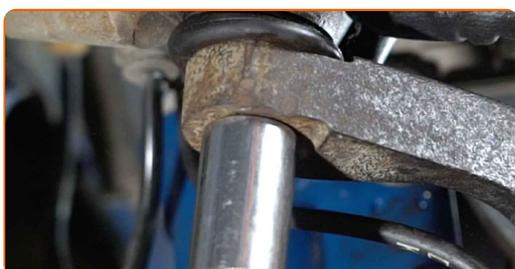
**69** Skru fast festet som kobler kulleledet til styrespindelen. Bruk en kombinasjonsnøkkel #13. Bruk en pipenøkkelinnsats #13. Bruk en skrallenøkkel.
