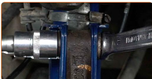
**32** Rengjør festet til ABS-sensoren. Bruk en stålbørste. Bruk WD-40 spray.
