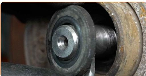
**17** Spre bremseklossene. Bruk et brekkjern.
