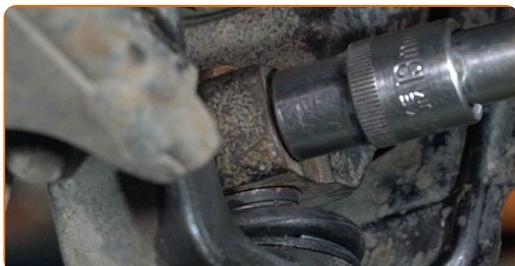
**70** Skru inn festet som forbinder fjærbeinet med styrespindelen. Bruk en kombinasjonsnøkkel #18. Bruk en pipenøkkelinnsats #18. Bruk en skrallenøkkel.
