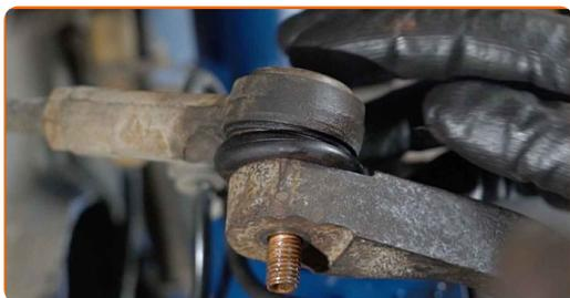
**68** Skru på festemutteren som kobler endeledet til rattspindelen. Bruk en pipenøkkelinnsats #17. Bruk en skrallenøkkel.
