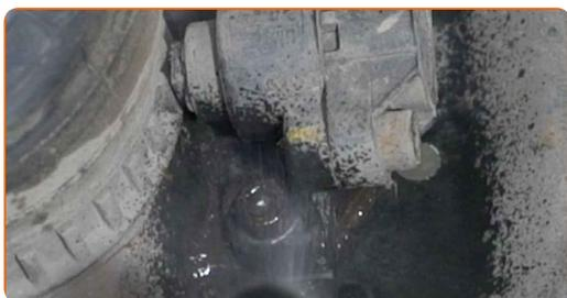
**33** Skru løs festet til ABS-sensoren. Bruk HEX nr. H5. Bruk en skrallenøkkel.
