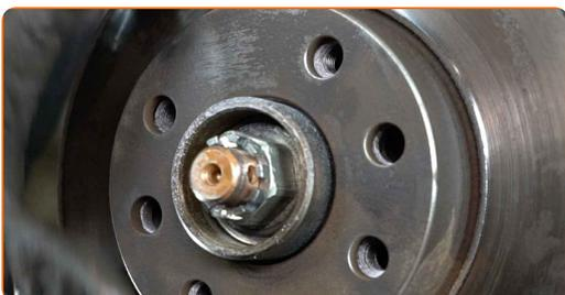
**75** Stram bremseskivefestet. Bruk en Philips-skrutrekker. Bruk en momentnøkkel. Stram den til 7 Nm dreiemoment.
