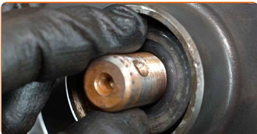
**72** Skru mutteren på drivakselen. Bruk en pipenøkkelinnsats #30. Bruk en skrallenøkkel.
