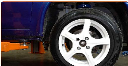
**11** Løsne festet til drivakselen. Bruk en pipenøkkelinnsats #30. Bruk et svingjern.
