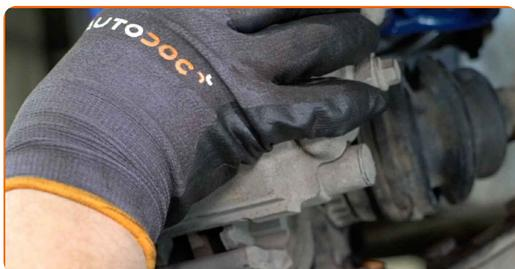
**77** Stram bremsekalipperbraketten. Bruk HEX nr. H10. Bruk en momentnøkkel. Stram den til 95 Nm dreiemoment.
