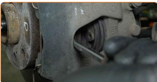
**18** Rengjør festene på braketten til bremsecaliperen. Bruk en stålbørste. Bruk WD-40 spray.
