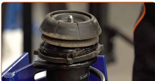
26 Stram fjærbeinets stempelstangmutter. Bruk en kombinasjonsnøkkel #19. Bruk en pipenøkkelinnsats #9. Bruk en momentnøkkel. Stram den til 50 Nm dreiemoment.
