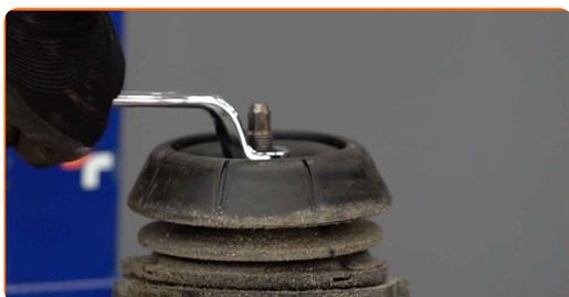
**20** Fjern støtdemperfestet, støvbeskytteren og støtstopperen.
