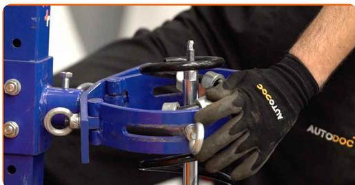
25 Installer monteringsmansjett og klosser i støtdemperen.
