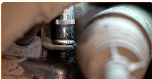
**15** Skru fast festene til stabilisatorstag brakettene. Bruk en pipenøkkelinnsats #E12. Bruk en momentnøkkel. Stram den til 35 Nm dreiemoment.
