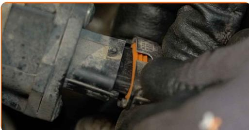
**4** Løsne låseklemmene som kobler luftfilterkanalen til luftfilterhuset. Bruk en Philips-skrutrekker.
