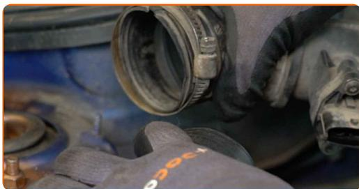
6 Løs klemmene som fester luftmengdemåleren til luftslangene. Bruk en flat skrutrekker.
