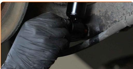
**18** Skru inn det nedre festet til støtdemperen. Bruk en pipenøkkelinnsats #E20. Bruk en skrallenøkkel.
