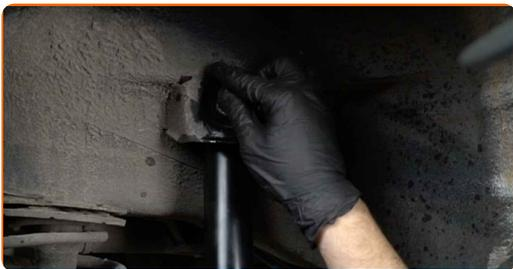
**16** Skru fast de øvre festene til støtdemperen. Bruk en pipenøkkelinnsats #E18. Bruk en skrallenøkkel.
