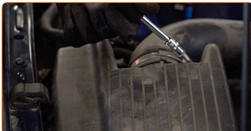
**5** Koble røret til luftinntaket fra luftfilterhuset.
